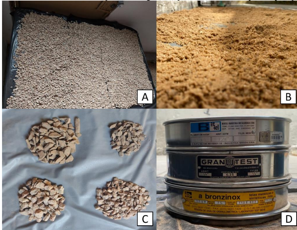
Figura 4.4. Preparação do material filtrante do BSF: a) cascalho de drenagem depois de exposto ao sol, b) areia de filtração no processo de secagem ao sol, c) diferença da granulometria do cascalho de filtração e drenagem, d) peneiras utilizadas para separação.
