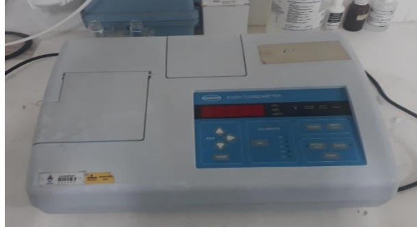
Figura 4.26. Equipamento para medição de turbidez, Turbidímetro HACH - 2100N, modelo 2100N.
