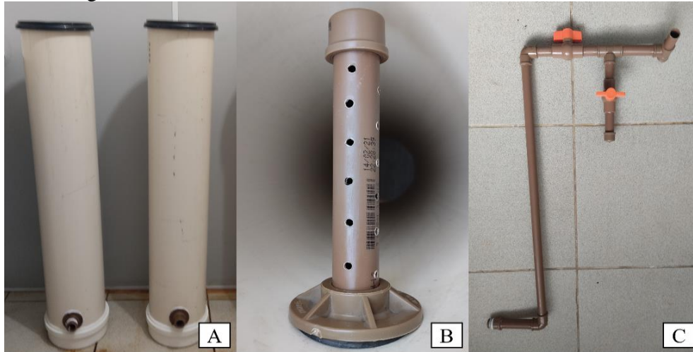
Figura 4.7. Construção dos BSF: a) corpo do filtro, instalados em duplicata, b) mecanismo de drenagem instalado na parte inferior do BSF, c) tubulação de saída do BSF, conectado ao sistema de drenagem do filtro.
