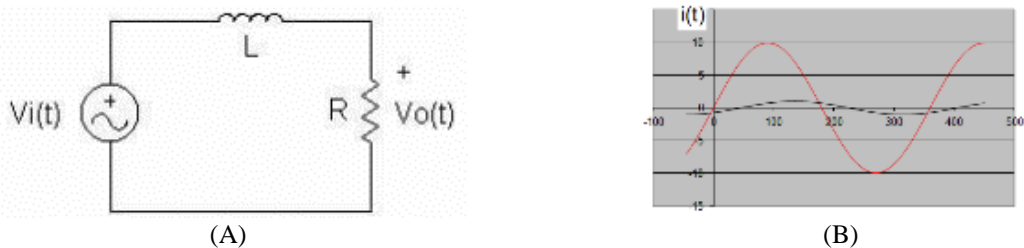
Figura 35 - Circuito RL: (A) Diagrama esquemático, (B) Formas de onda de tensão e corrente.
