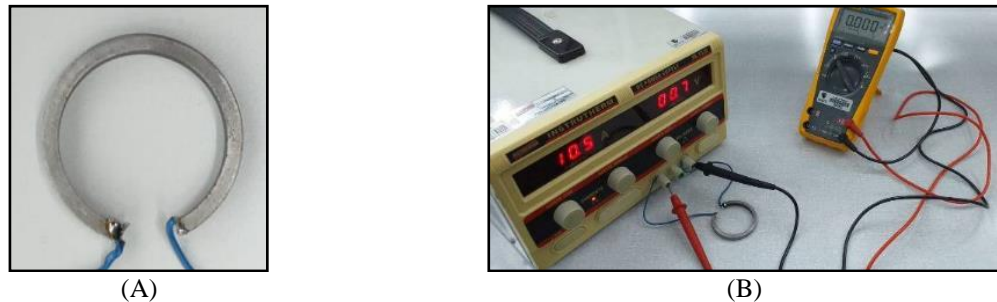
Figura 31 - Determinação da resistividade: (A) Anel cortado com os fios soldados, (B) Conectados a fonte elétrica e medição.
