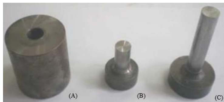
Figura 19 - Matriz para fabricação dos corpos de prova na forma de cilindro, A - Matriz, B - Punção superior, C - Punção inferior.
