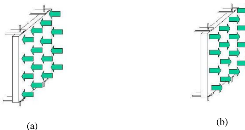
Figura 25 – Envoltória de pressão: (a) sobrepressão e (b) sucção
