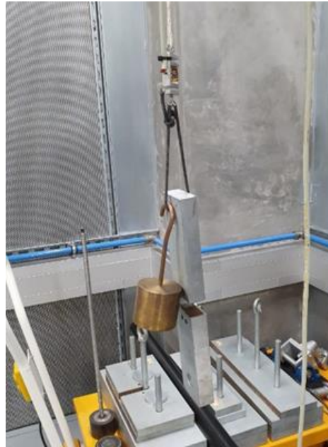
Figura 7 – Calibração da célula de carga. Fonte: do autor
