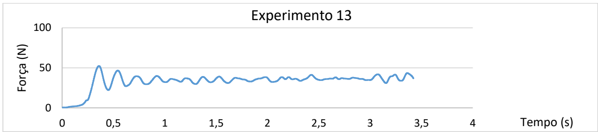
Figura A-14 – Gráfico de força de tração em relação ao tempo para o experimento contendo o perfil de roda alto, superfície de madeira e inclinação de 15°.
