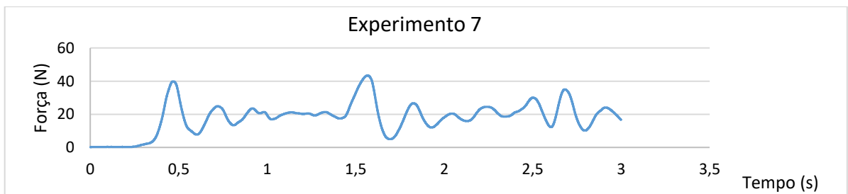
Figura A-8 – Gráfico de força de tração em relação ao tempo para o experimento contendo o perfil de roda baixo, superfície de madeira e inclinação de 15°.
