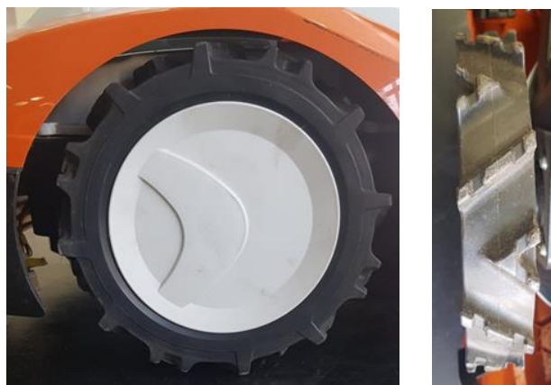
Figura 2 – Imagens da roda de perfil alto. À esquerda uma vista lateral e à direita a vista superior. Fonte: do autor
