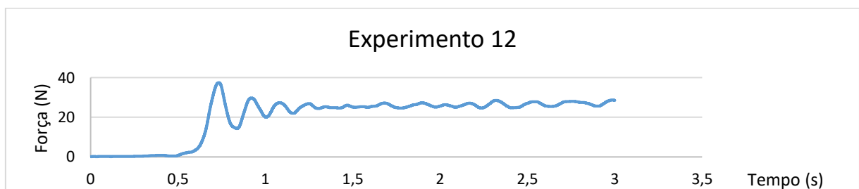
Figura A-12 – Gráfico de força de tração em relação ao tempo para o experimento contendo o perfil de roda alto, superfície de madeira e inclinação de 0°.
