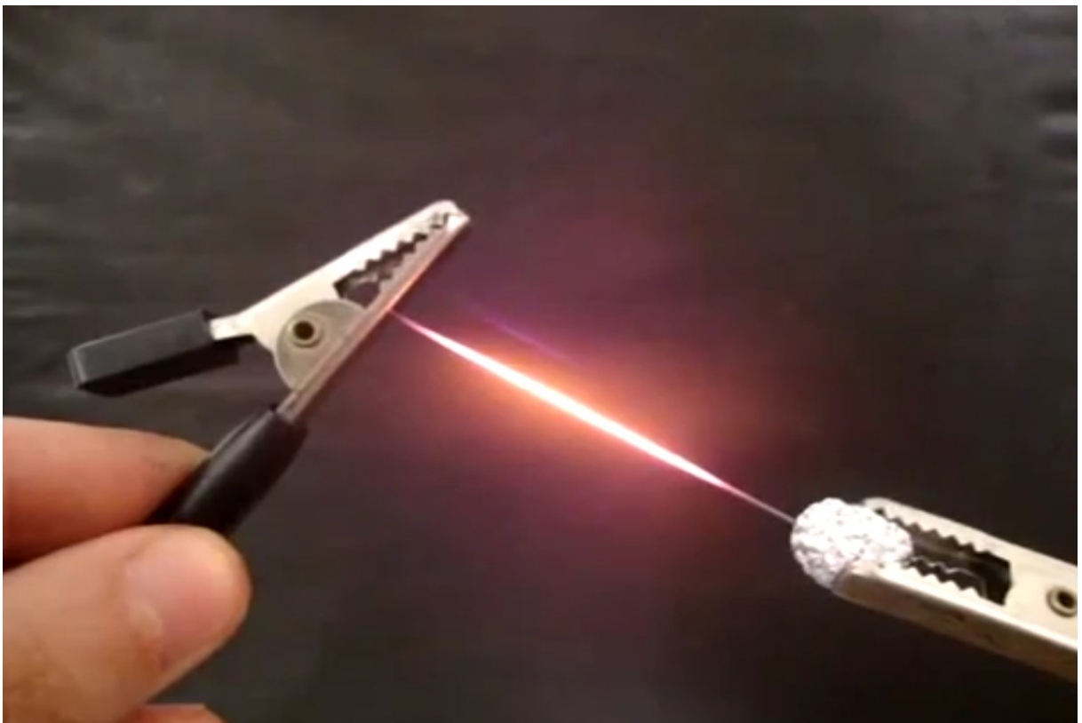
Figura 3: Demonstração do efeito Joule em uma lâmina de grafite. Foto retirada de um vídeo apresentado em aula.
