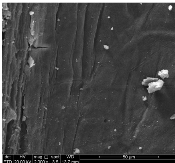
Figura 67 – Casca retirada do Compósito ampliação de 2000 vezes (Elaboração própria)
