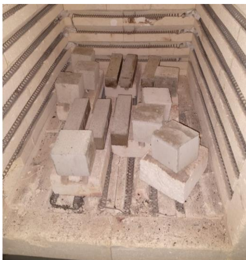
Figura 121 – Amostras dispostas em forno mufla para ataque térmico
