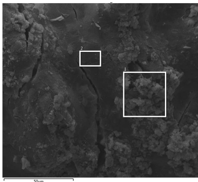
Figura 104 – Microanálise da superfície externa da casca de arroz extraída do Compósito submetido a solução de hidróxido de sódio (Elaboração própria)
