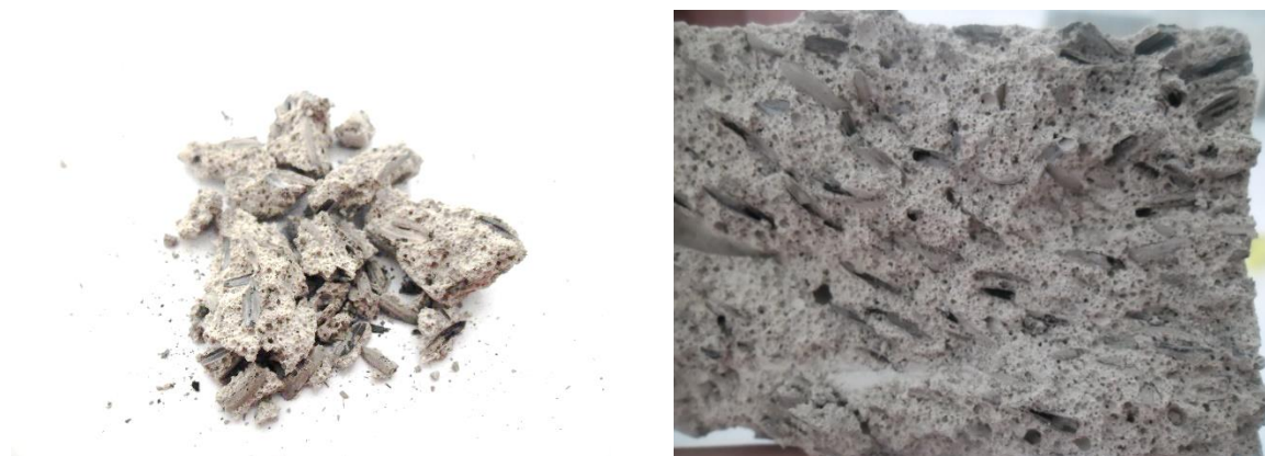
Figura 123 – Casca de Arroz do Compósito submetido a 300°C (Elaboração própria)
