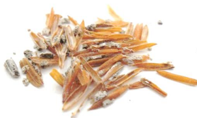
Figura 96 – Casca de Arroz do Compósito que ficou 56 dias em NaOH (Elaboração própria)
