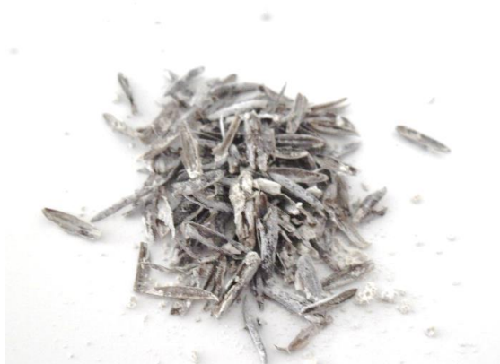
Figura 109 – Casca de Arroz do Compósito que ficou 42 dias em H_2SO_4 (Elaboração própria)
