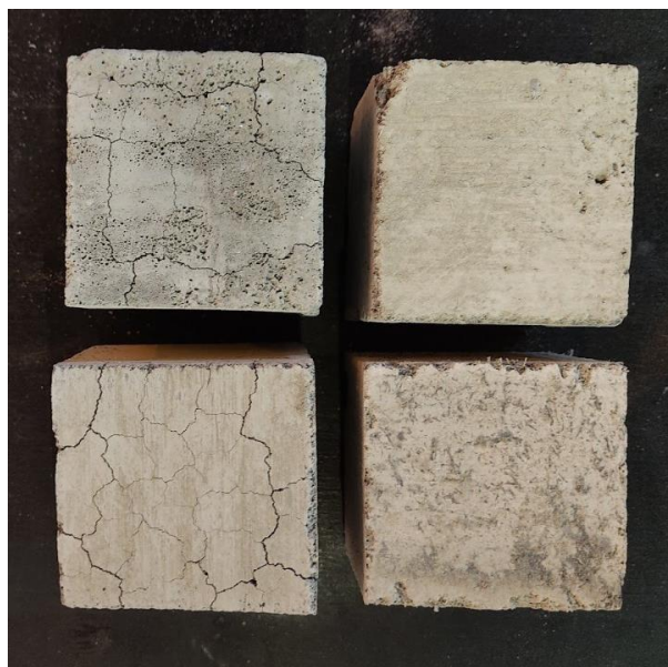
Figura 124 – Amostras Referência (à esquerda) e Compósitos (à direita) após uma hora na mufla a 650°C (Elaboração própria)
