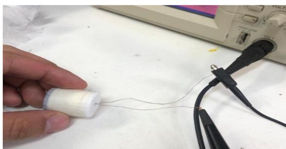
Figura 14 – Conexão do ressonador ao canal 1 do Osciloscópio.
