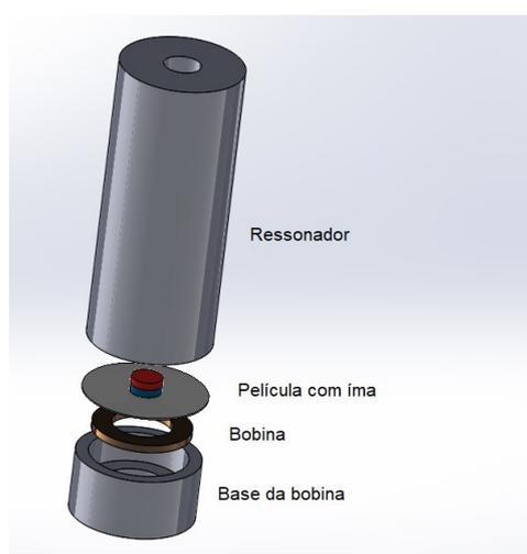
Figura 7 - Vista explodida do ressonador eletromagnético
