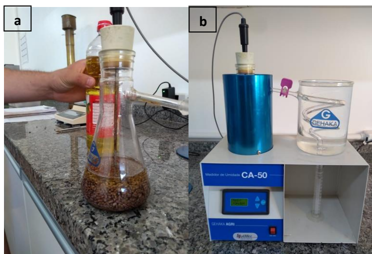
Figura 7- medidor de umidade direto CA-50 (a) Sementes cobertas por óleo vegetal. (b) Aparelho montado e pronto para iniciar o aquecimento.
