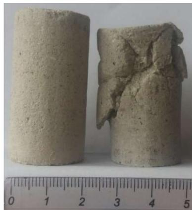
Figura 38: Imagem de um corpo de prova (a) antes e (b) após o ensaio de compressão.
