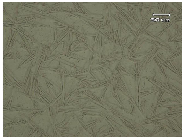
Figura 4.12- Chapa liga M ( 200x), ataque com 30 ml de ácido acético glacial, 5ml de ácido nítrico e 2 ml de ácido fluorídrico .
