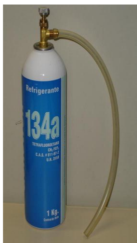
Figura 3.6- Gás refrigerante 134a para resfriamento de amostras até -23,6^\circ\text{C} .
