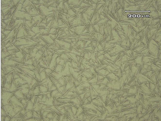
Figura 4.13 - Liga termotivada 3M (x200), ataque com 30 ml de ácido acético glacial, 5 ml de ácido nítrico e 2 ml de ácido fluorídrico.
