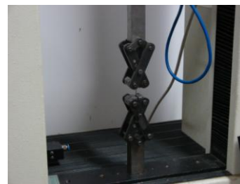
Garra mecânica utilizada na tração do fio.
