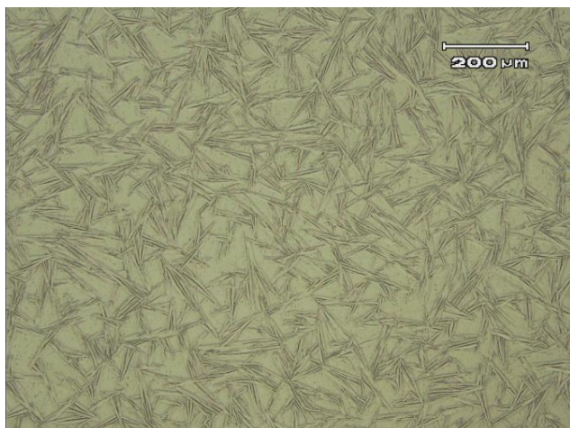
Figura 4.11 - Chapa liga M ( 100x), ataque com 30 ml de ácido acético glacial, 5ml de ácido nítrico e 2 ml de ácido fluorídrico .
