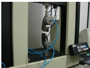
Garra pneumática utilizada na tração da chapa.
