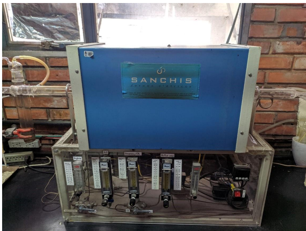
Figura 26 – Reator CVD utilizado na deposição dos nanotubos de carbono.
