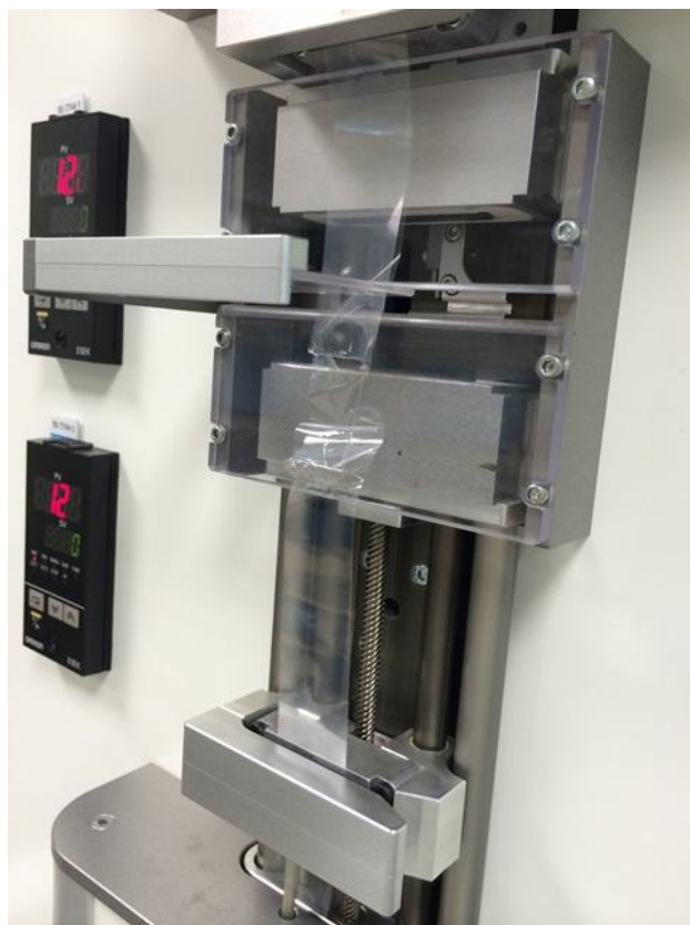
Figura 14: Ensaio da solda ( hot tack ) em aparelho J&B.
