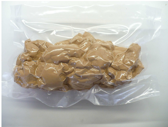
Figura 4.5: Material dentro do saco plástico com vácuo, pronto para ser extrudado.
