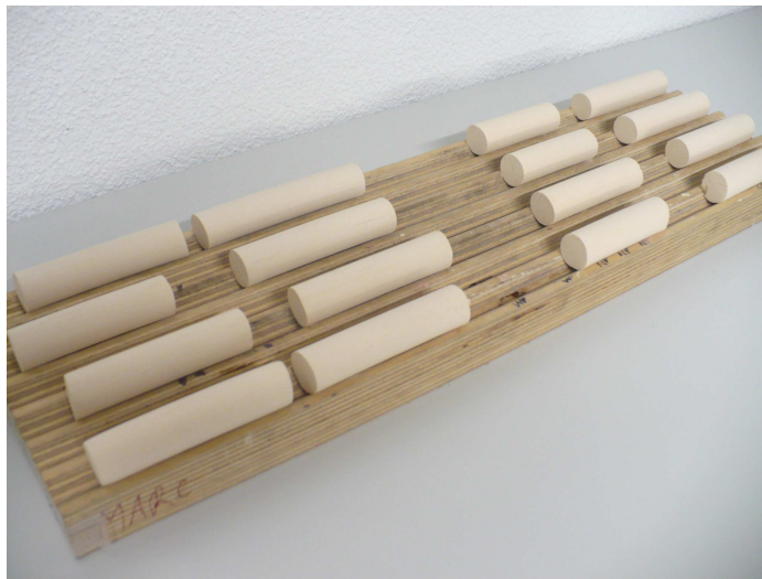
Figura 4.9: Cilindros secos prontos para serem sinterizados.
