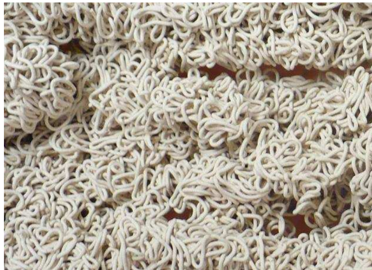
Figura 4.7: Material extrudado em um molde com orifício 0.5mm.
