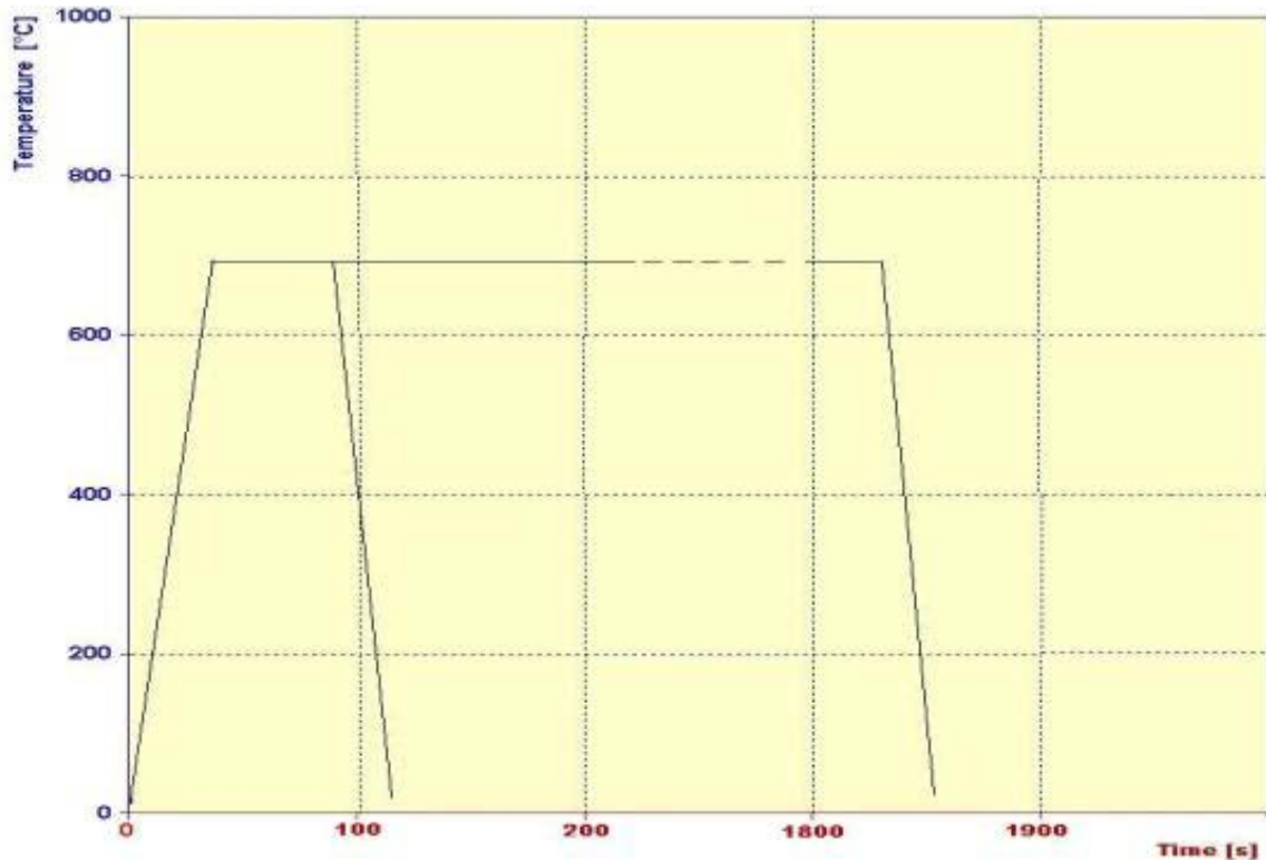
Figura 3-4 - Aço DP980Z - Amostras mantidas por um ou trinta minutos em 650°C, para verificar o desenvolvimento da recristalização.
