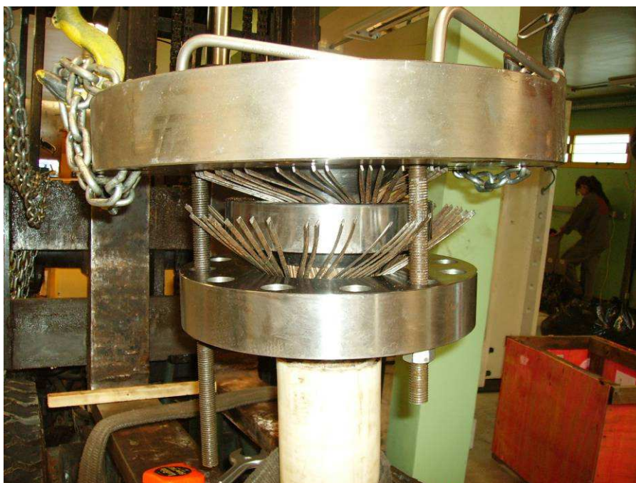
Figura 4-13. Detalhe da montagem do conector de aperto(LAMEF).
