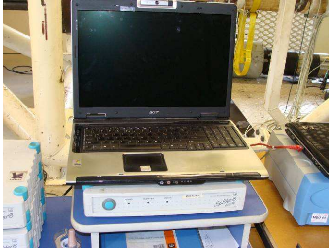
Figura 4-9 – Sistemas de aquisição de dados empregados no ensaio no pórtico(LAMEF)
