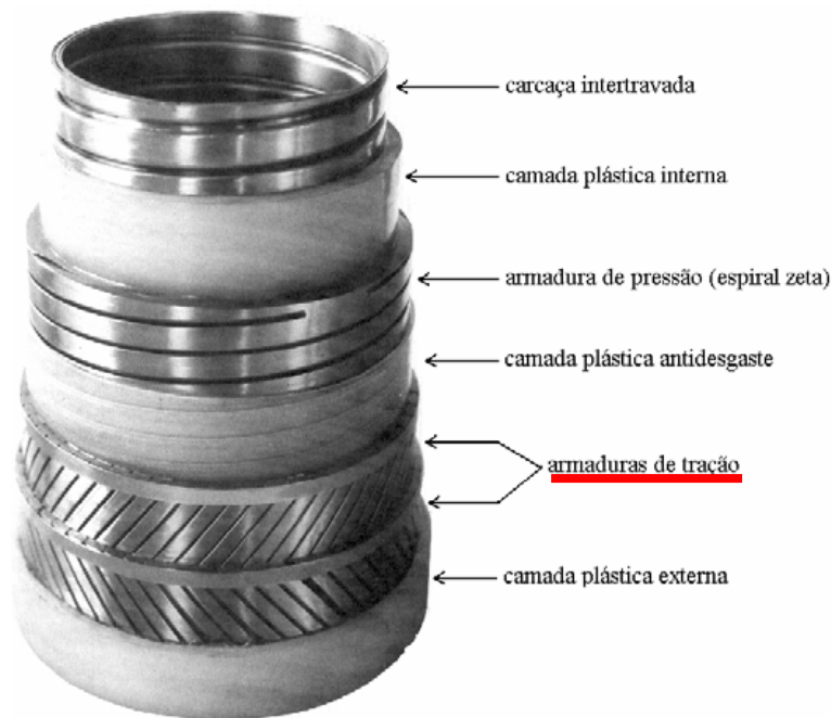
Figura 1-4. Dutos de camadas não aderentes ( unbonded ou non-bonded )(Sousa, 2005)
