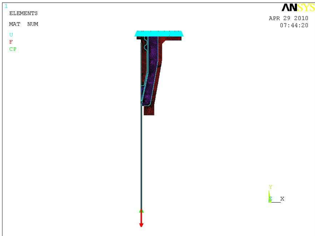
Figura 4-33. Modelo axissimétrico com a capa.
