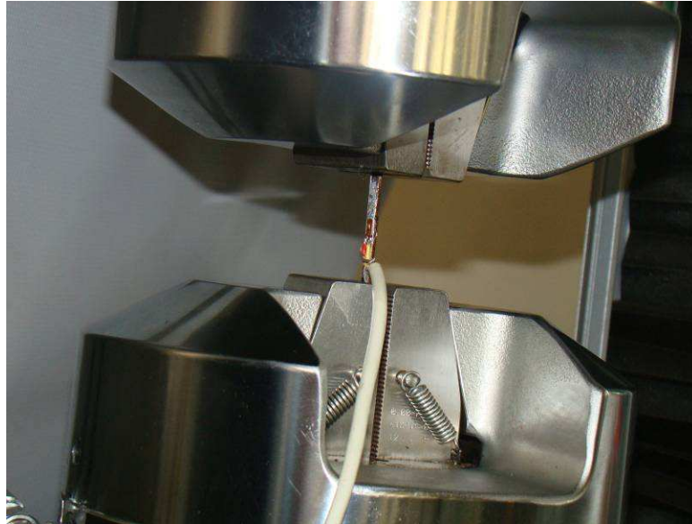
Figura 4-1. Montagem de tendão instrumentado na máquina de tração
