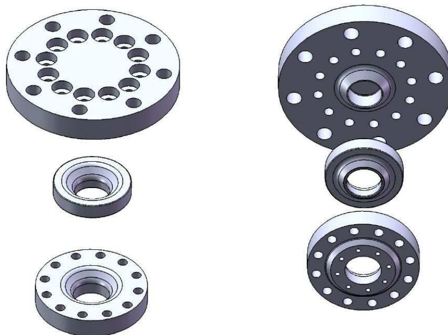
Figura 4-12. Vista explodida do conector de aperto.
