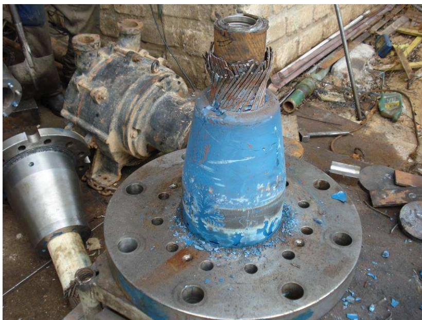
Figura 5-7. Detalhe da resina após a remoção da capa do conector.
