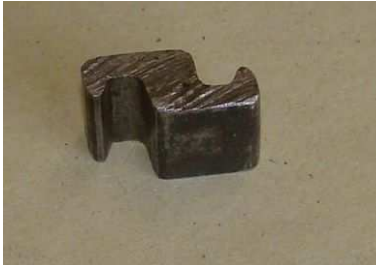
Figura 1-8. Fotografia de seção da camada de pressão do riser estudado(LAMEF).
