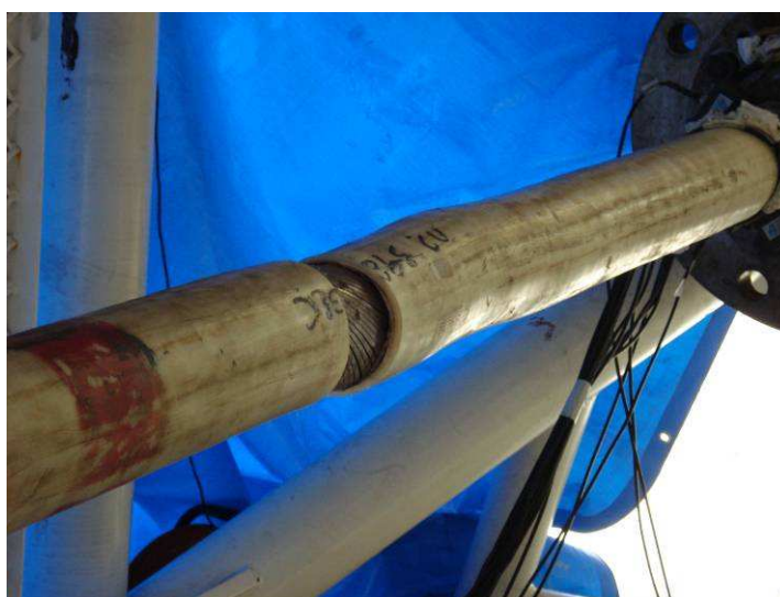
Figura 6-1. Detalhe da deformação da capa externa do riser na bancada.
