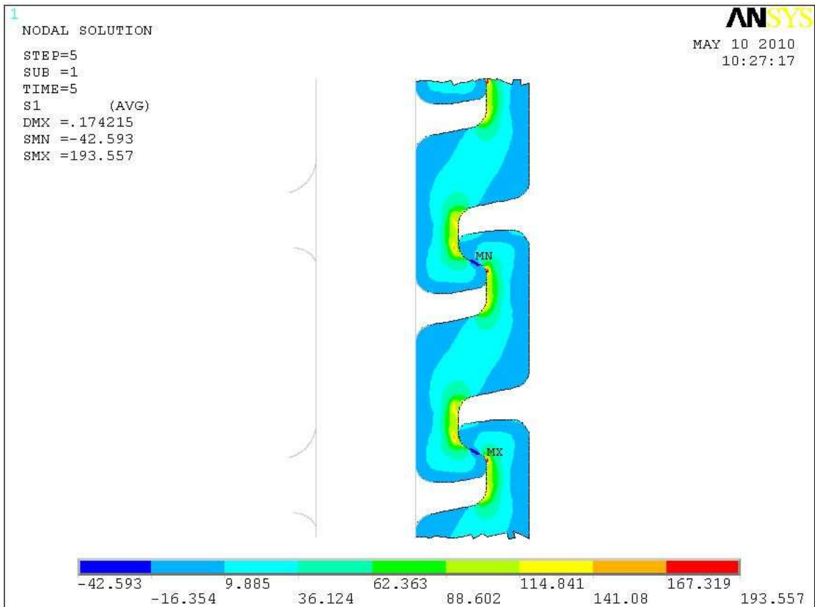
Figura 5-76. Tensões principais máximas na Camada de Pressão com carga de 130 kN.
