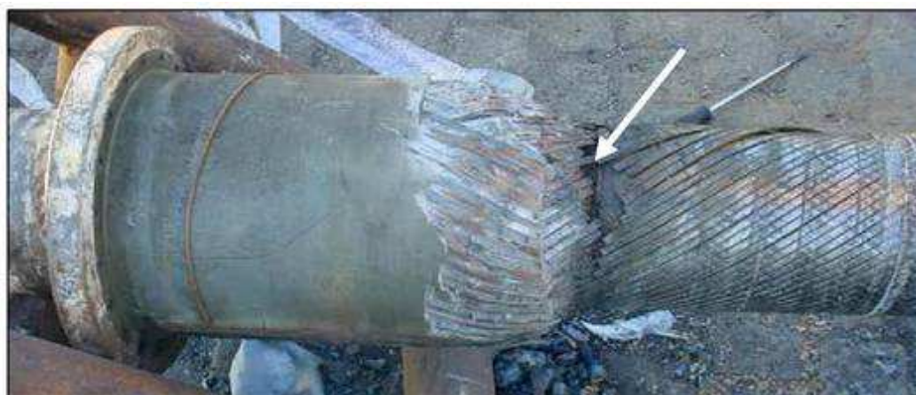
Figura 1-12. Detalhe da ruptura de tendões próximos a interface com conector (M. G. Marinho et. al. ,2007)
