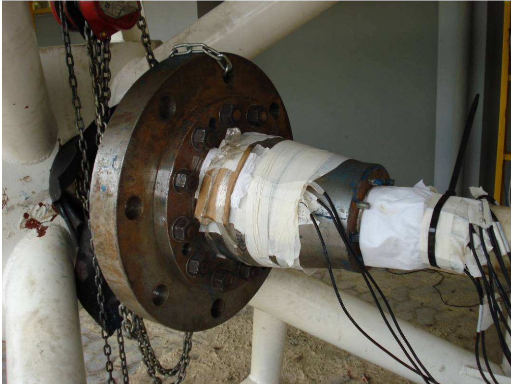
Figura 4-22. Detalhe da instrumentação junto ao conector do lado oposto ao atuador(LAMEF)
