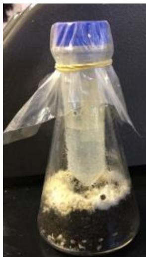
Figura 7 – Célula respirométrica utilizada para biodegradação.
