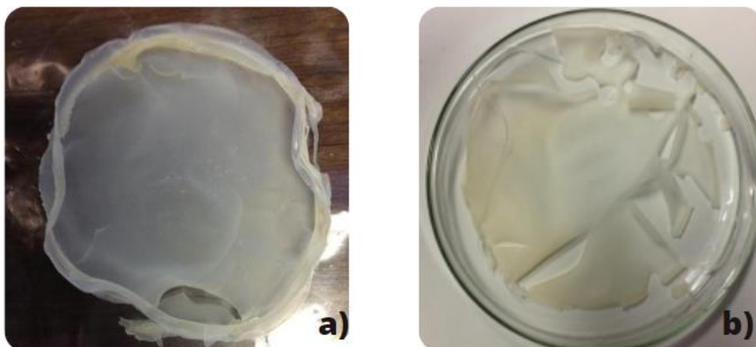
Figura 8 – Filmes de PHB, onde a) contém 5% de GC e b) contém 10% de GC.
