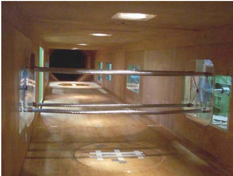
FIGURA 5.7: Modelo composto de um feixe de 04 cabos Rook com espaçamento de 10 diâmetros entre cabos
