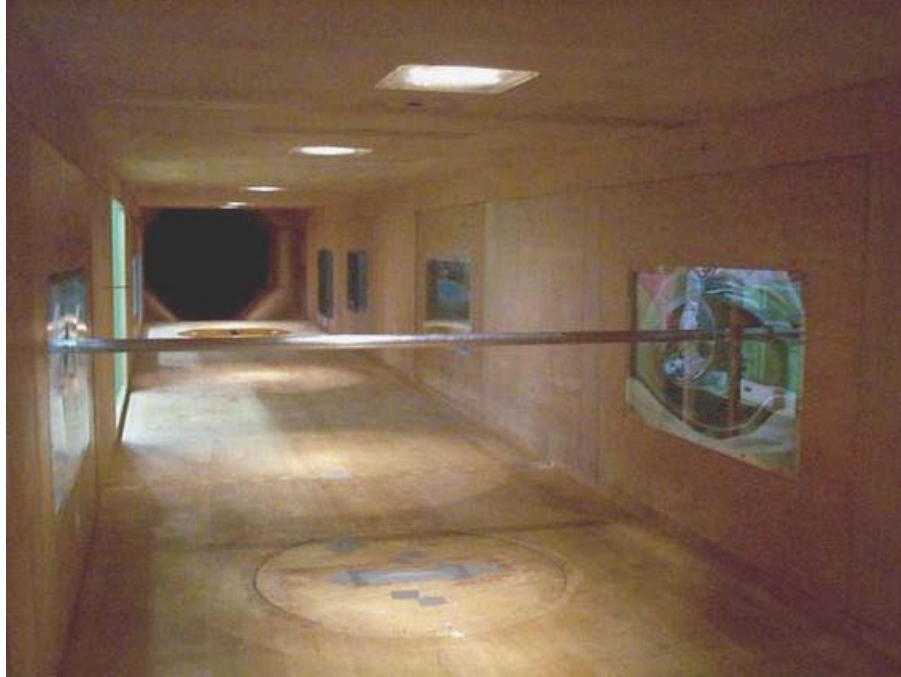
FIGURA 5.5: Modelo composto de um cabo liso de 25mm de diâmetro
