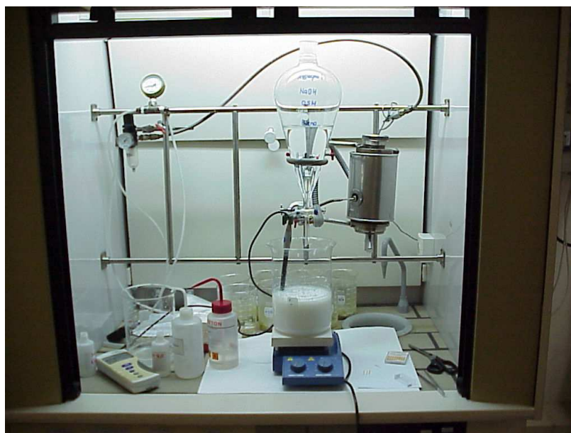
Figura 47. Montagem das vidrarias e acessórios utilizados na síntese do material mesoestruturado pela Rota II.
