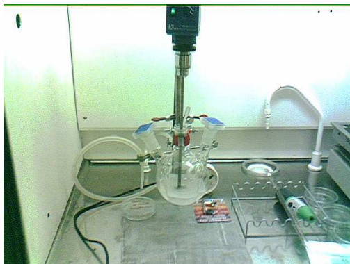
Figura 45. Montagem do reator. Início da reação, mostrando meio reacional turvo.
