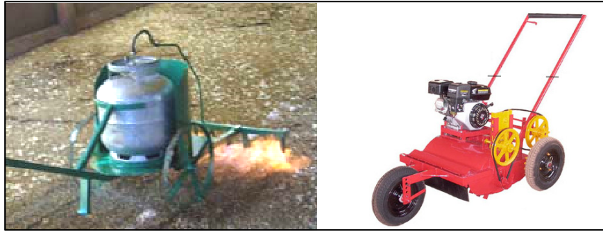
Figura 4.1 – Equipamentos comercializados: a) esquerda : queimador de penas; b) direita : revirador de cama com motor a gasolina.
