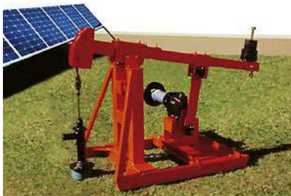
Figura 8 – Unidade de Bombeio ativada por Energia Solar
