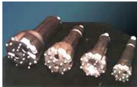
Figura 7 - Ferramentas para Perfuração por Roto-Pneumática
