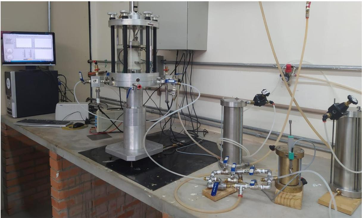
Figura 3.8: Equipamento triaxial utilizado
