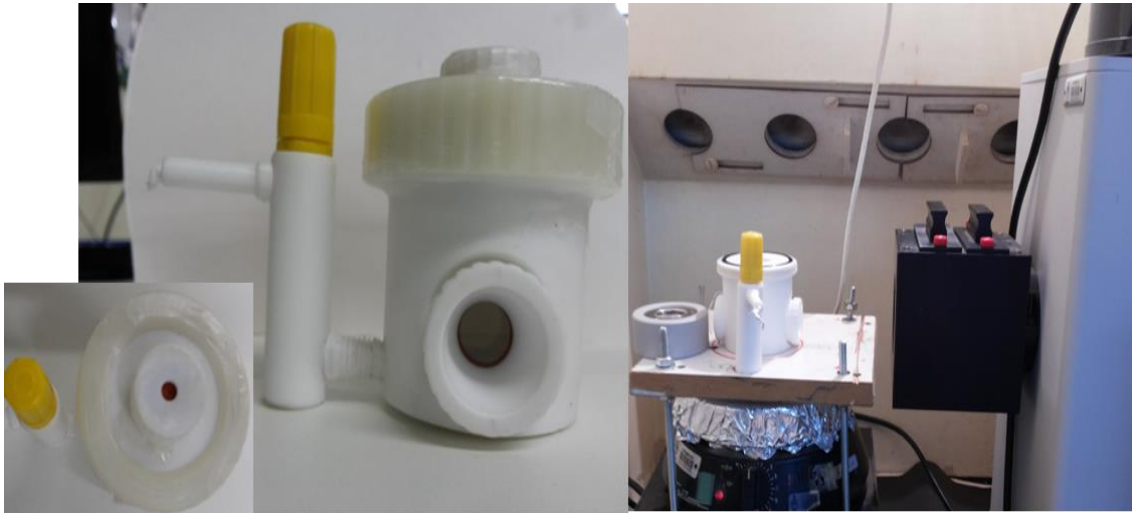
Figura 3. Imagem do reator fotocatalítico utilizado nas reações de geração de H_2 e fonte de irradiação.
