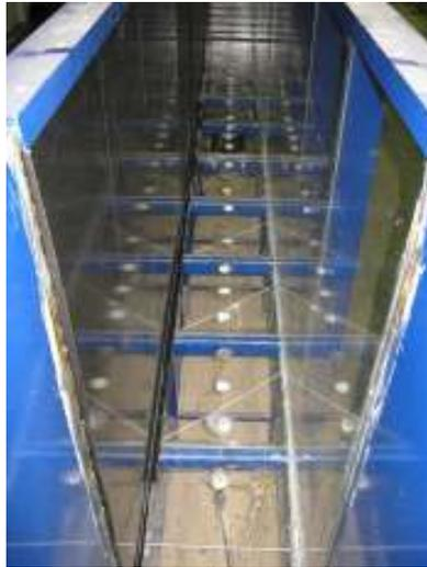
Figura 22: interior do canal da bacia de dissipação (largura = 0,40 m)
