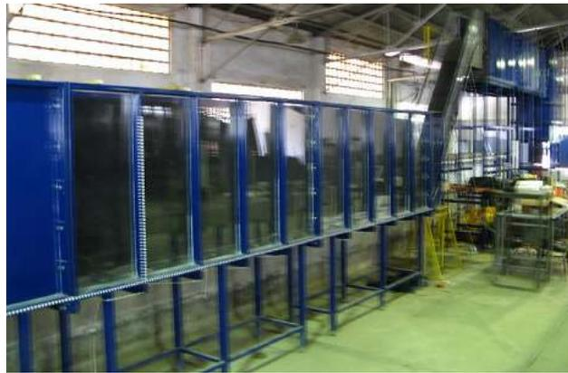
Figura 21: modelo de sistema de dissipação vertedouro-bacia
