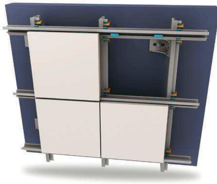
Figura 09 – Fixação através de estrutura indireta
