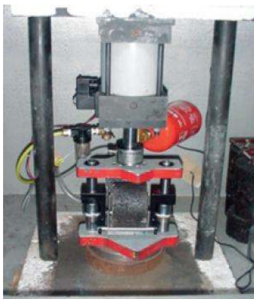
Figura 6: equipamento para ensaio de compressão diametral de carga repetida em misturas asfálticas (BERNUCCI et al., 2006)
