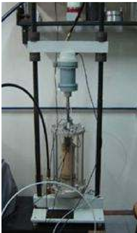
Figura 5: equipamento do laboratório de pavimentação da UFRGS para determinação do módulo de resiliência em solo-agregado
