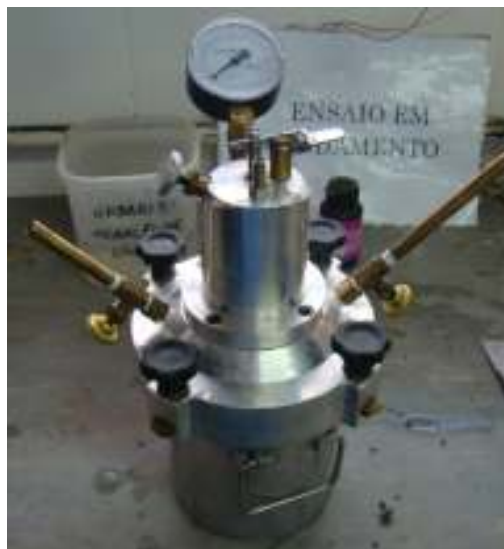
Figura 17: aparelho utilizado para a determinação de teor de ar incorporado
