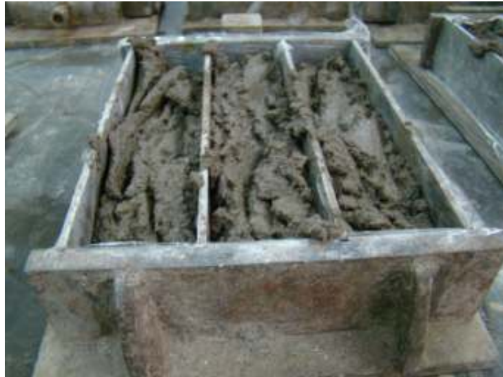
Figura 11: exemplo da moldagem dos corpos-de-prova prismáticos
