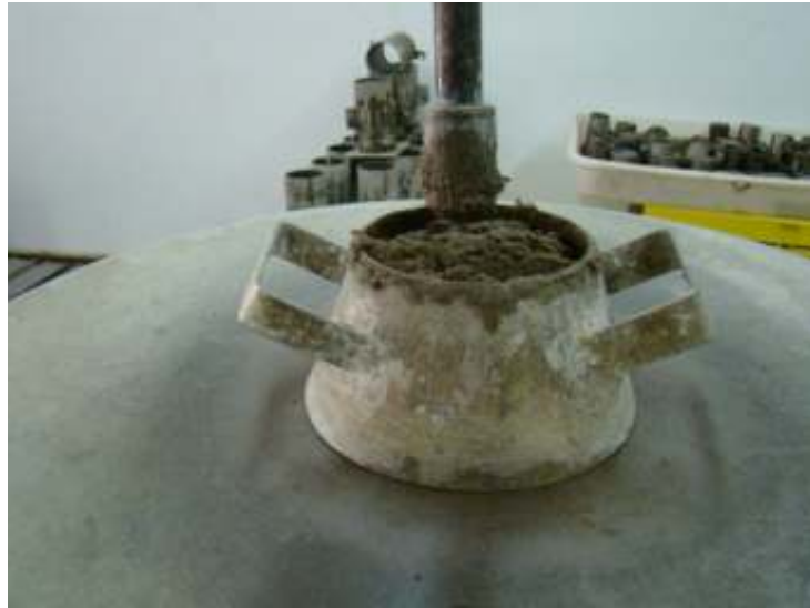
Figura 10: realização do ensaio de consistência das argamassas
