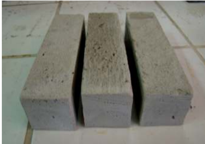
Figura 12: corpos-de-prova prismáticos 4x4x16cm desmoldados
