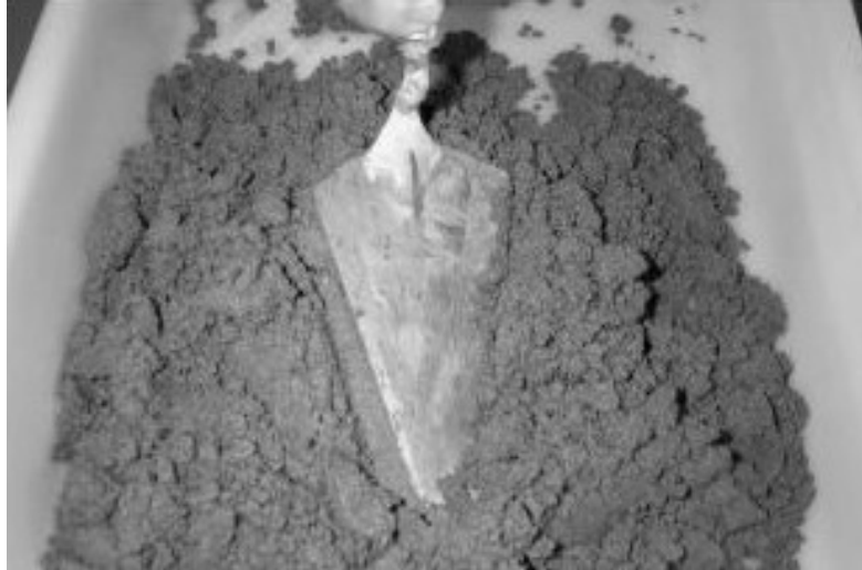
Figura 2: argamassa sem aditivo incorporador de ar com aspecto seco (ALVES; Ó, 2005, p. 32)
