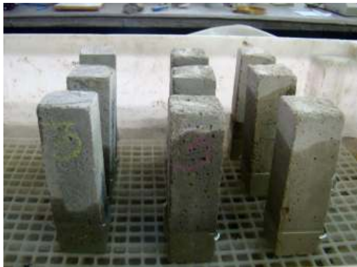
Figura 21: detalhe da diferença de comportamento dos traços de argamassas ao ensaio de absorção de água por capilaridade
