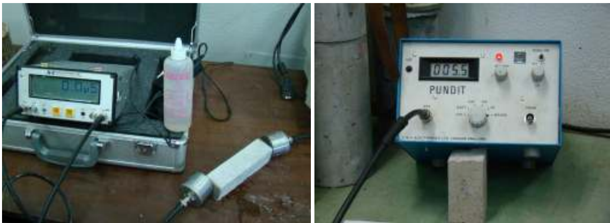
Figura 15: equipamentos utilizados para determinar o módulo de deformação dinâmico das argamassas ensaiadas
