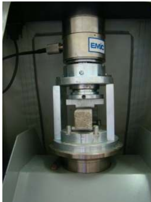
Figura 13: detalhe da ruptura dos corpos-de-prova
