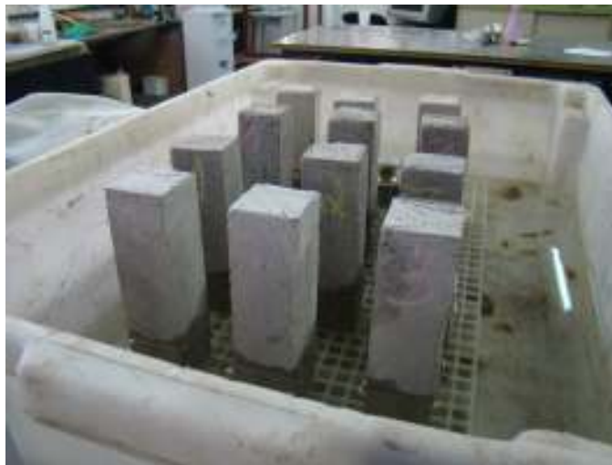
Figura 14: detalhe do ensaio de absorção de água por capilaridade
