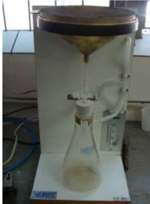
Figura 16: aparelho para determinação da retenção de água das argamassas
