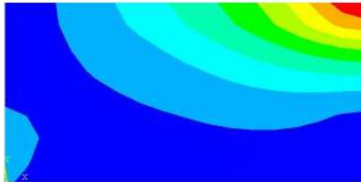
Figura 41: momentos  $M_y$  para placa 2 com elementos de 25 cm
