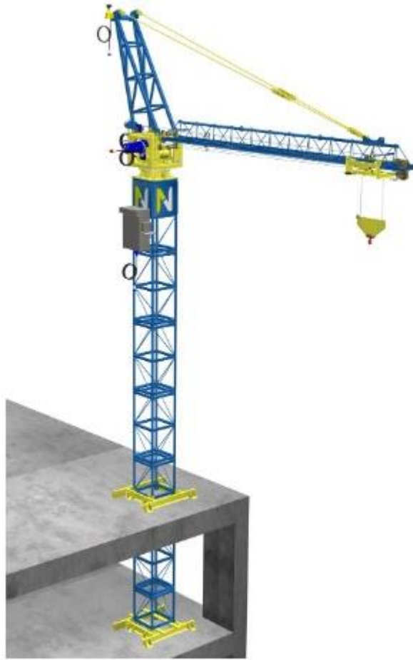
Figura 20 – Representação gráfica de uma grua ascensional
