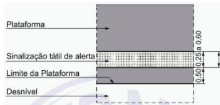
Figura 24 – Sinalização tátil de alerta no limite de plataformas
