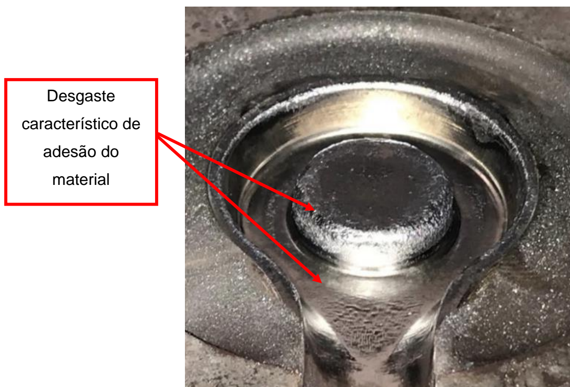
Figura 44: Cavidade após 4000 peças, apresentou desgaste.
