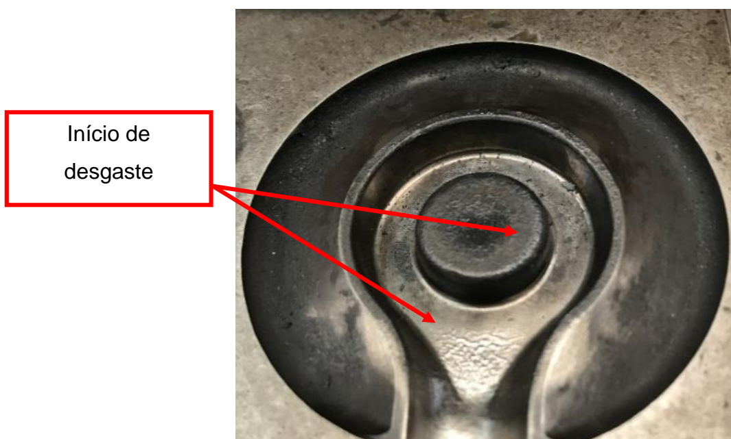
Figura 43: Superfície Matriz após 1000 peças
