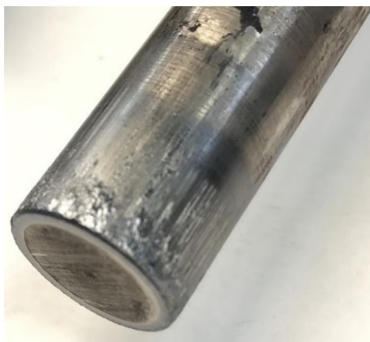
Figura 41: Punção após primeiro lote de 1000 peças
