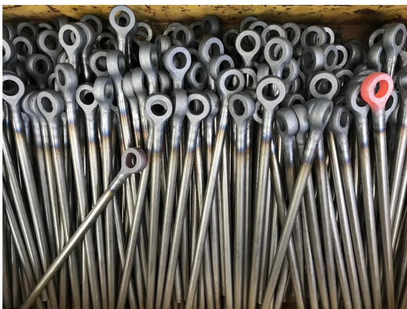
Figura 38: Primeiro lote de 1000 peças forjados
