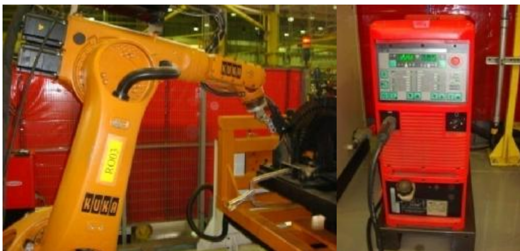
Figura 3.4 Robô KR 30-3 e fonte de potência TPS 5000.
