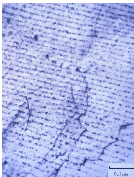
Figura 2.7 – Precipitados de carboneto de vanádio obtidos pelo resfriamento brusco de um aço Fe-0,75%, V-0,15%, C-0,10%, de 1150°C para 725°C e então um envelhecimento da amostra nesta temperatura por 5 minutos [REED-HILL 1994].
