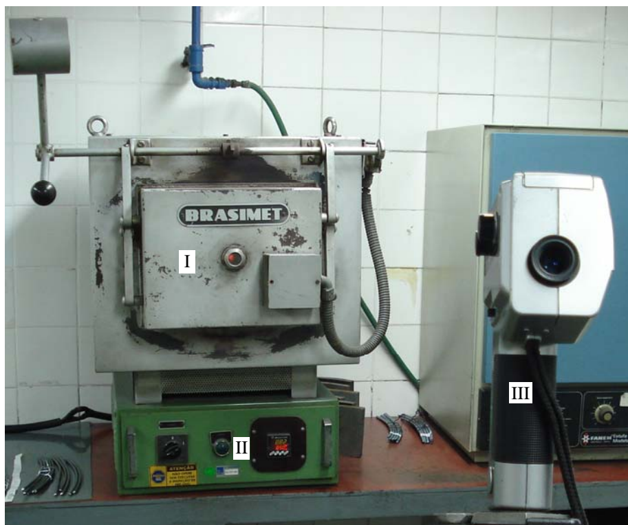
Figura 3.24: Equipamentos usados na simulação em laboratório das temperaturas de laminação. I – Forno; II – Comando do forno; III – Pirômetro óptico.
