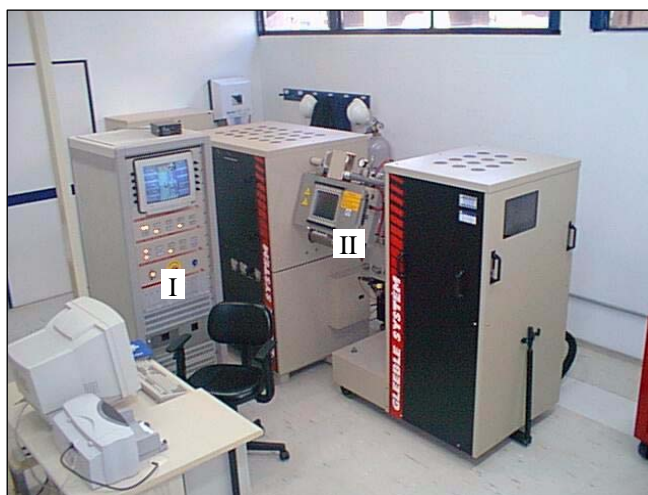
Figura 3.1: Simulador Termomecânico Gleeble 3500. I – Módulo de comando; II – Câmara de ensaios.
