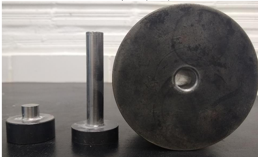
Figura 12 – Matriz de compactação mostrada de perfil, junto com os punções inferior (menor) e superior (maior).
