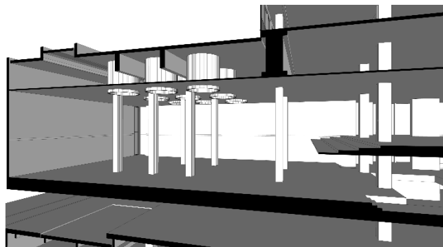
41 - Figura que representa o espaço com apoios seguindo a malha estrutural da torre - Imagem do autor
