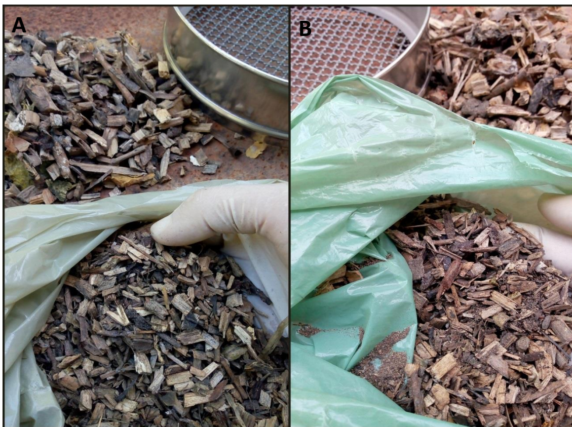
Figura 10 – Composto em processo de peneiramento (malha de 6,3 mm).
