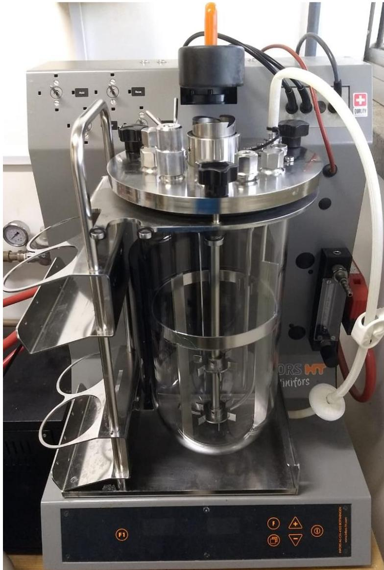
**Figura 4:** Foto do fermentador *Infors Minifors* do fabricante INFORS HT. Fonte: Autor
