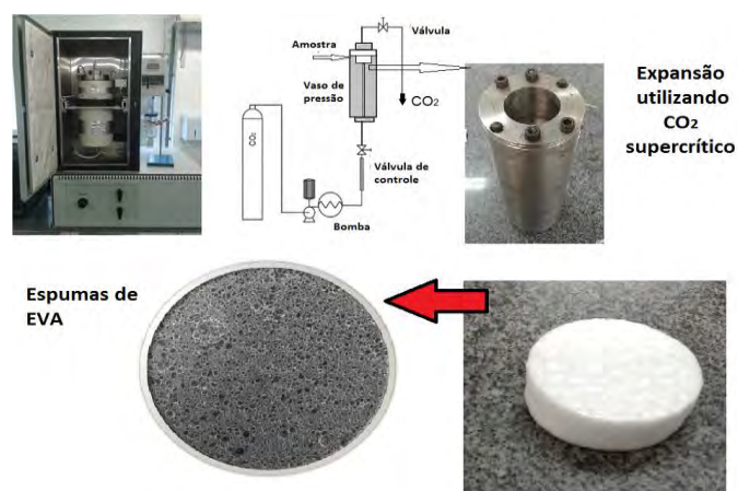
Figura 1: Equipamento utilizado para expansão e das espumas de EVA.
