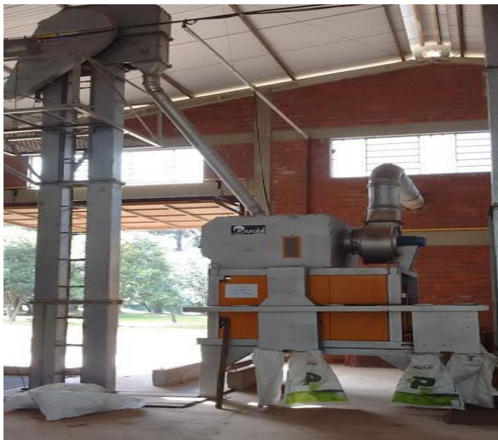
FIGURA 1. Máquina de ar e peneiras (MAP) da marca Ferrabil, utilizada para a realização da pré-limpeza nos grãos de milho no Pólo de pós-colheita da Estação Experimental Agronômica (EEA- UFRGS), no município de Eldorado do Sul, RS. Eldorado do Sul, 2017.
