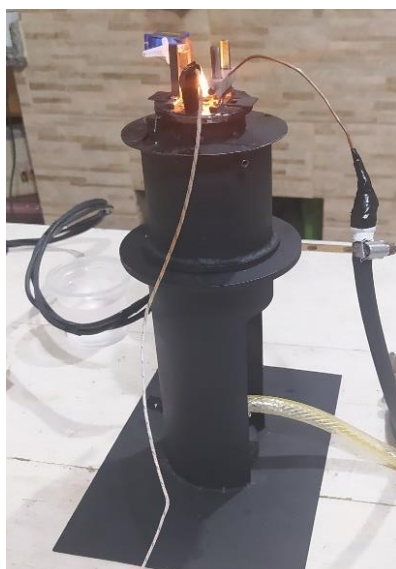
Figura 4 – a) Bancada Tag Vaso Fechado fabricada; b) Tampa da bancada.
