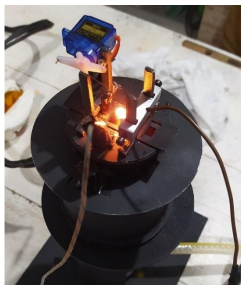
Figura 4 – a) Bancada Tag Vaso Fechado fabricada; b) Tampa da bancada.
