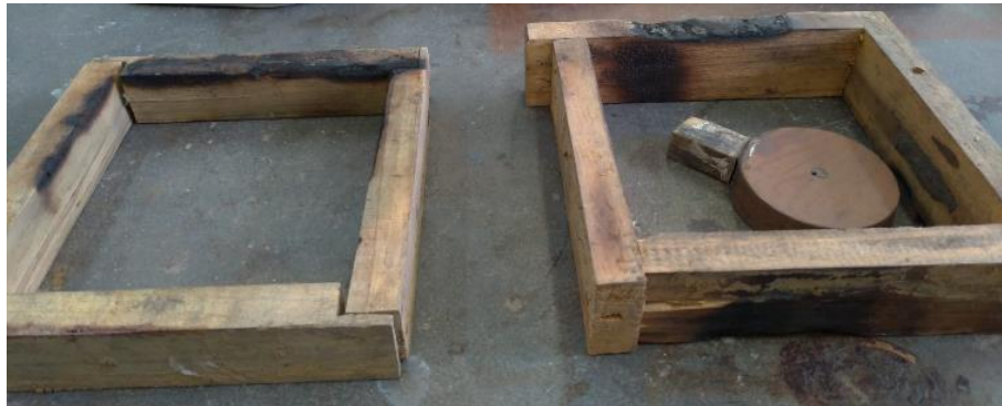
Figura 13 – Caixa fundo (esquerda) e caixa tampa (direita) na presença do modelo de madeira antes da etapa de moldagem.
