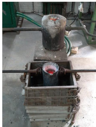
Figura 16 – Sistema com a panela de reação (acima) e o cadinho (abaixo) responsável pelo vazamento.
