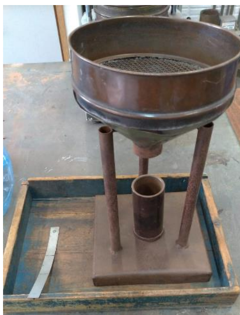
Figura 12 – Conjunto necessário para realizar o CP do ensaio de compactabilidade.
