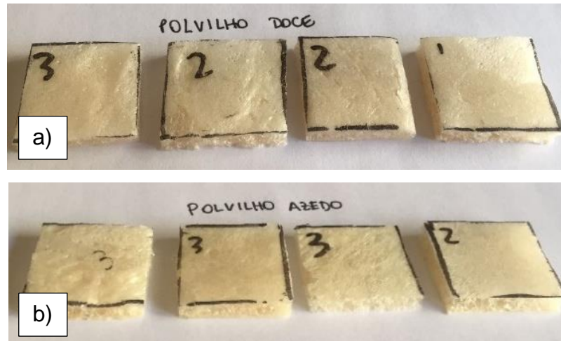
Figura 12: Corpos de prova para o ensaio de densidade. (a) Da esquerda para direita, amostra Bco PD, PD 0,5%, PD 1% e PD 2%. (b) Da esquerda para direita, Bco PA, PA 0,5%, PA 1% e PA 2%.
