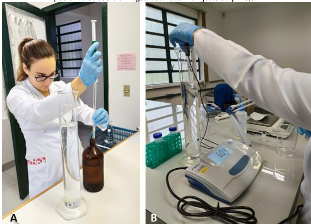
Figura 5 – A: Manipulação de ácido hipocloroso 0,015% através da diluição de hipoclorito de sódio em água destilada. B: Ajuste de pH 6,0.
