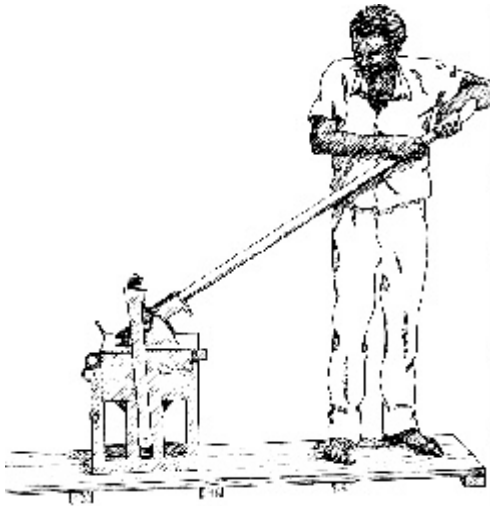
Figura 8 – Prensa manual CINVA-RAM
