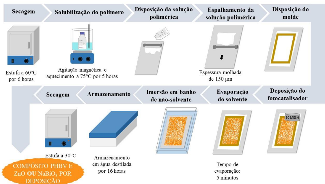
Figura 3.2 - Ilustração das etapas de preparação de compósitos de PHBV por deposição do fotocatalisador.
