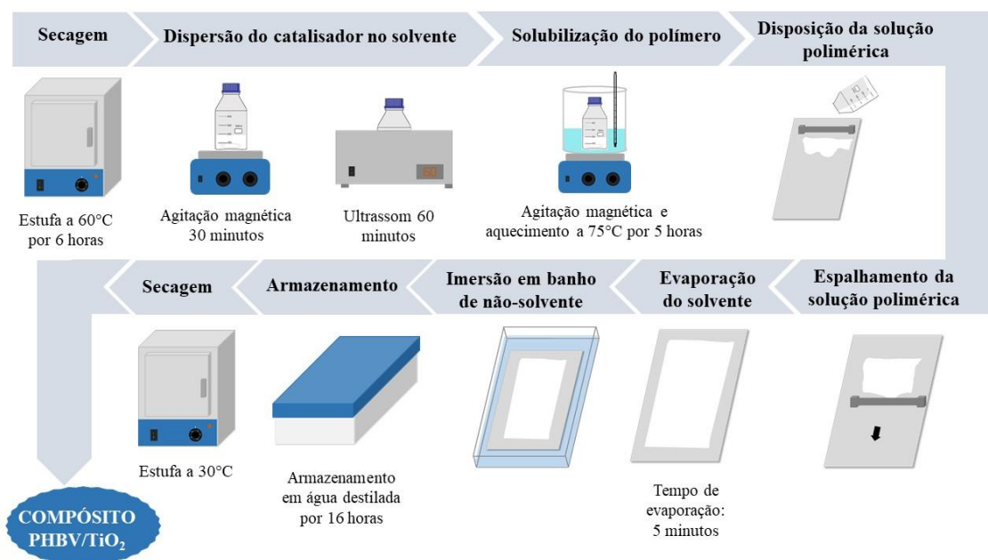
Figura 3.1 - Etapas de preparação dos compósitos de TiO 2
