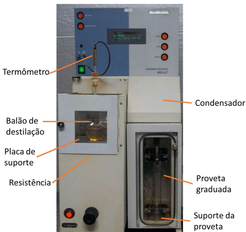
Figura 4: Destilador automático e indicações dos principais componentes. Fonte própria.
