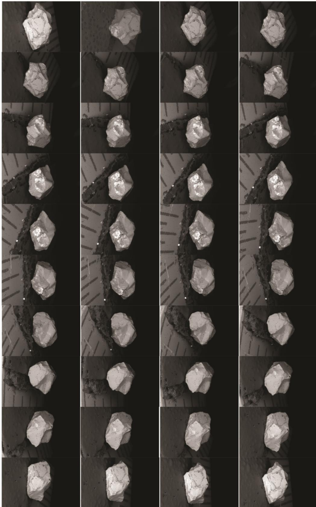
Lado 1 – 40 aquisições obtidas no MEV para a sequência da Fotogrametria
