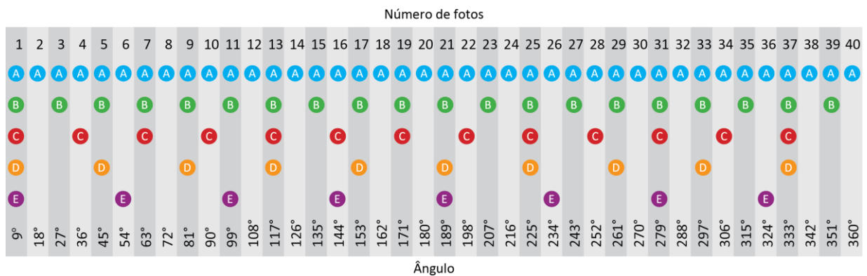
Figura 19. Aquisições em inclinação de 60° no MEV e sequenciamento de passos.
