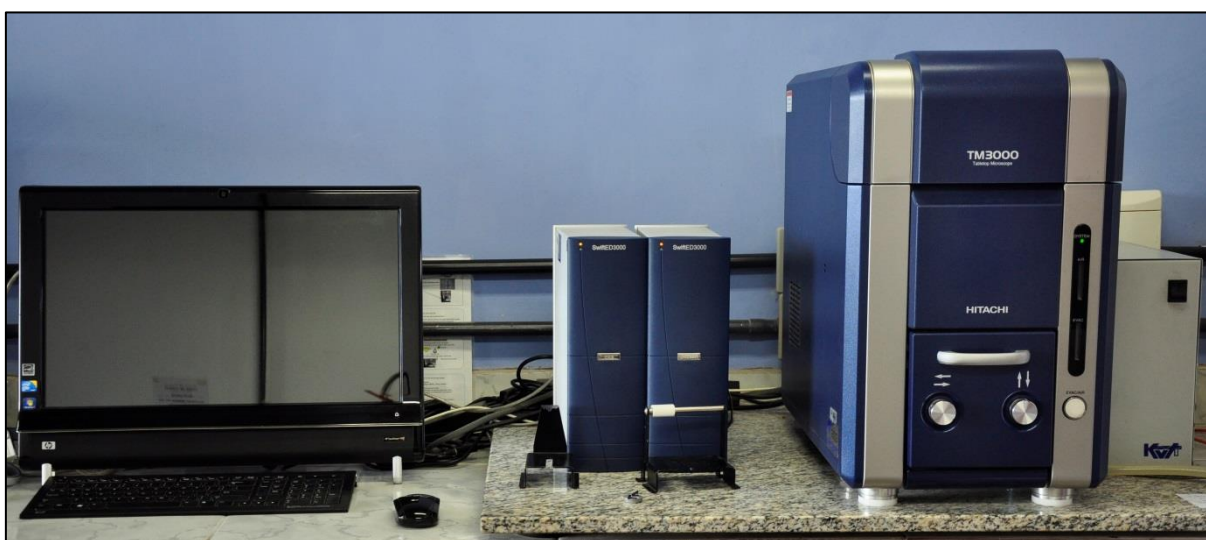
Equipamento de Microscopia Eletrônica de Varredura Hitachi TM3000 do LdSM – UFRGS. Fonte: Autor
