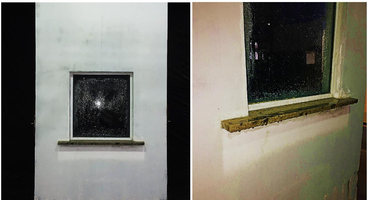
Figura 11 - Ensaio de chuva colorida na Parede 2 (parede com corte de indução da chuva para o centro da janela)
