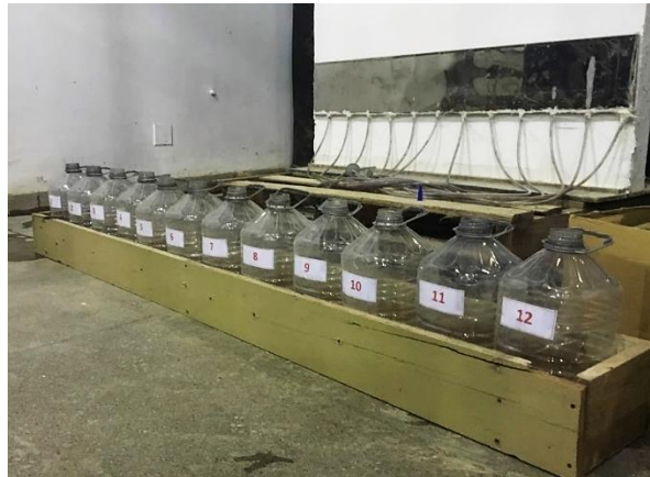
Figura 8 - Sistema de coleta de água, com as mangueiras desconectadas dos recipientes
