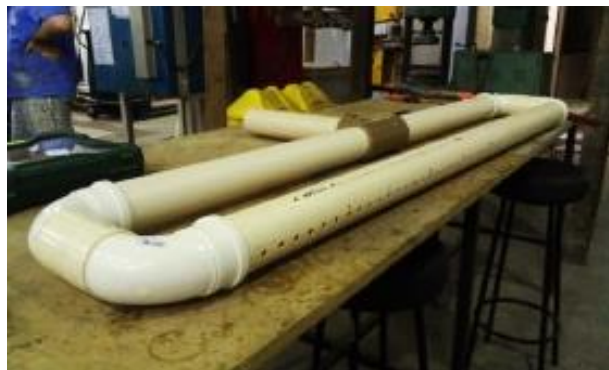
Figura 6 – Tubulação empregada no sistema de dispersão do ar
