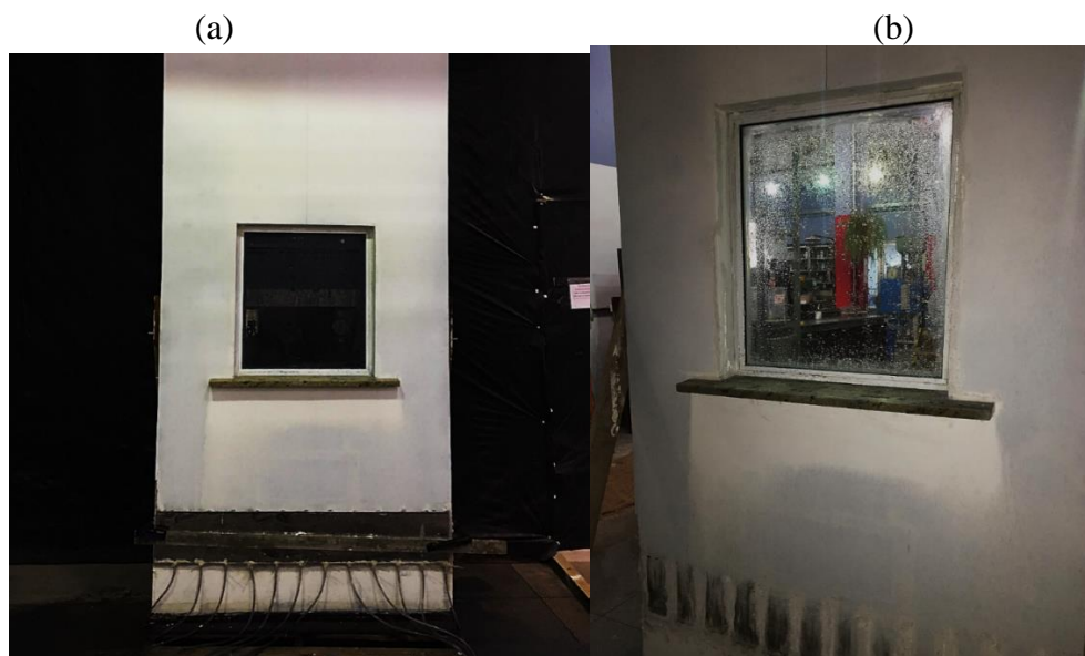
Figura 3 - Ensaio de chuva colorida na Parede de Referência (PR)
