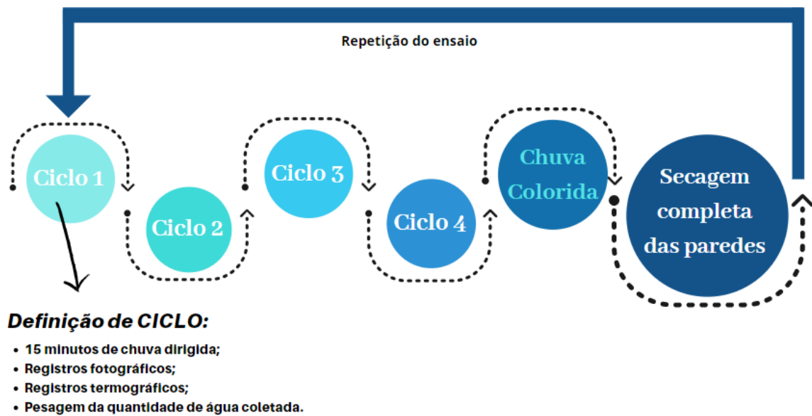
Figura 7- Método do ensaio de chuva dirigida e avaliação
