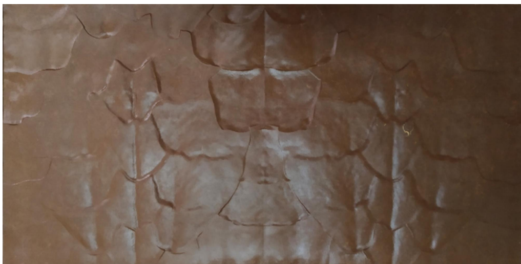
Figura 5 - Molde usinado em baquelite em 600x300mm
