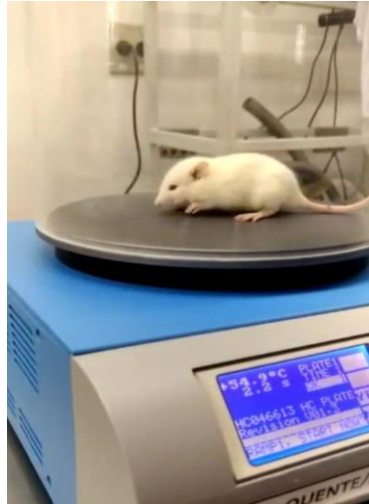
Figura 4. Aparato onde é realizado o teste da Placa Quente. A superfície metálica mantém a temperatura constante de \pm 55^{\circ}\text{C} . Créditos da imagem: Roberta S Toledo.
