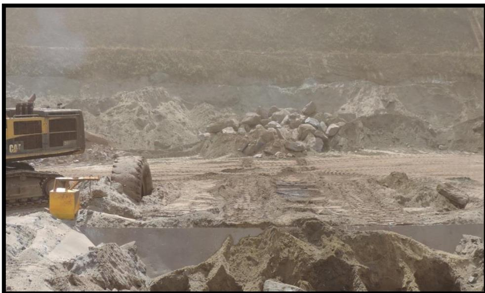
**Figura 3: Matacão de 1400 mm com características lamelares retirado da grelha do britador pela escavadeira.**
