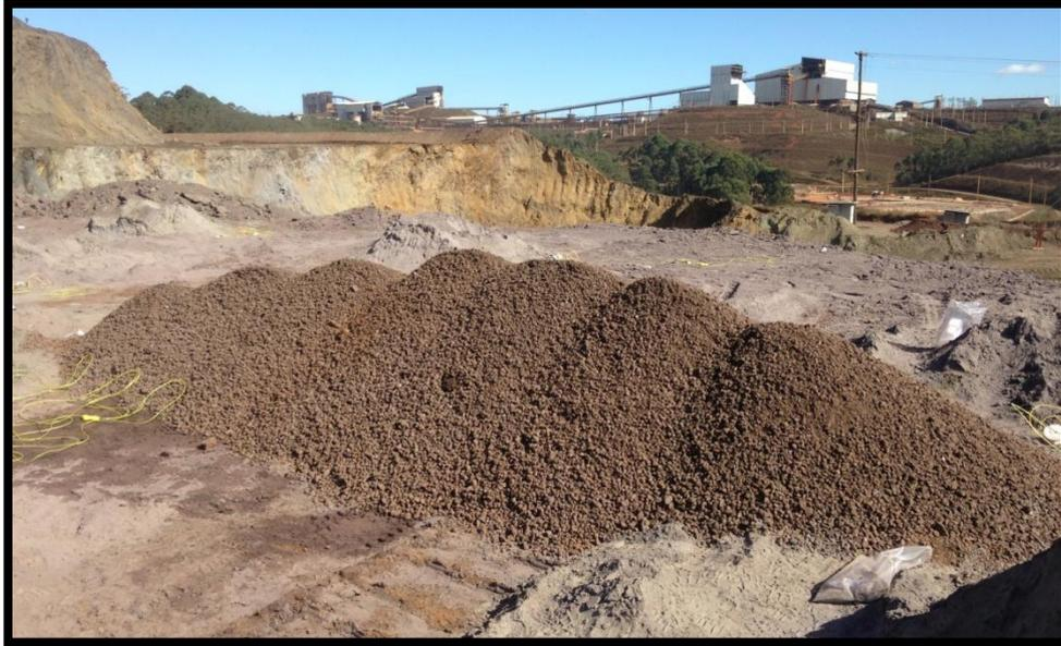
A Figura 31 mostra o ultra lançamento do desmonte realizado com o uso dos dois tipos de tampão, para efeito de comparação. Os furos laterais foram carregados com pó de perfuração e os centrais com o expurgo, o que deixa muito claro a maior eficiência de confinamento com o material granulado.
