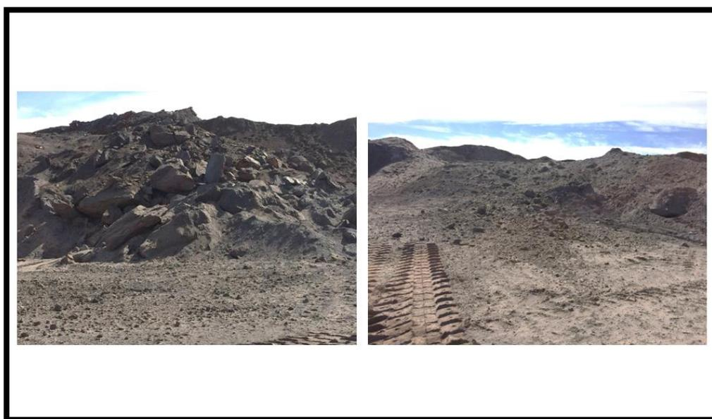
**Figura 40: Empilhamento do material desmontado no teste 4, com aplicação de estudo geofísico.**
